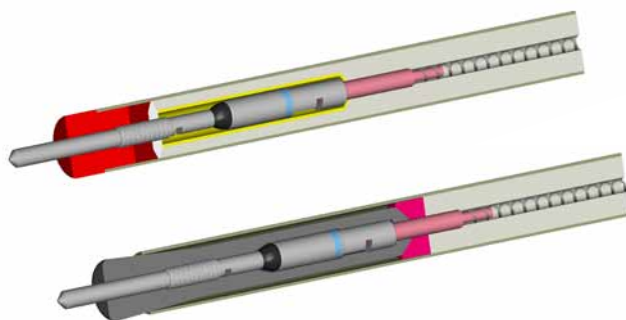
Rörelement med monterad smältsäkring.
